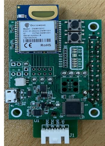
Fig. 11. Tag-module PCB
